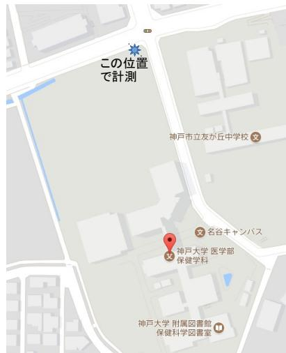
1. デジタル粉塵計（内蔵バッテリーの充電が十分であることを確認する）と騒音計と外付けバッテリー（充電済であることを確認する）を持って測定場所（上図参照）に行く。デジタル粉塵計も騒音源となるため、約 3 メートルの間をおいて測定準備する。
